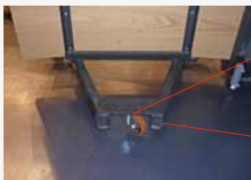
Rotello girevole con gomma Vulkollan con cuscinetto a sfera
